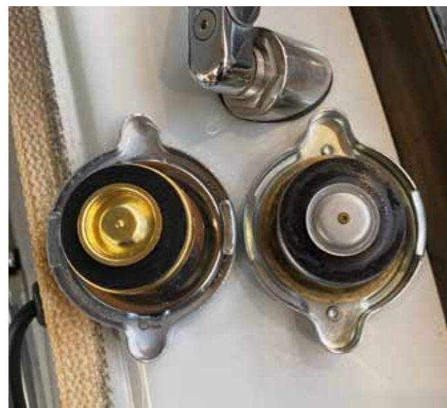
Links der neue Verschluss des Ausgleichgefäßes. Der Deckel lässt den Überdruck schneller entweichen
