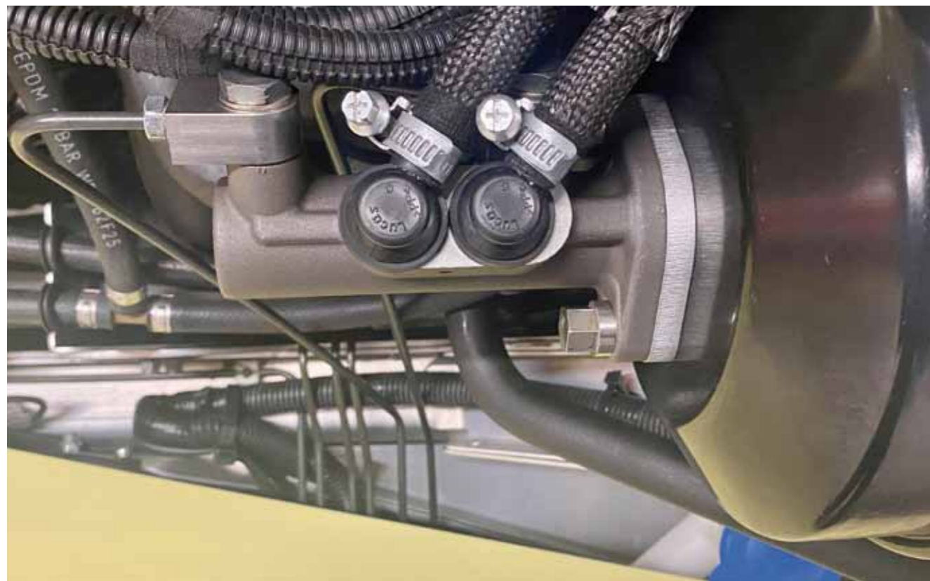
So sieht der neue Bremszylinder von dem italienischen Hersteller LPR an meinem Morgan aus. Wie man sehen kann, waren die Anschlüsse nicht alle baugleich mit dem Original und deshalb mussten verschiedene Leitungen neu verlegt werden
