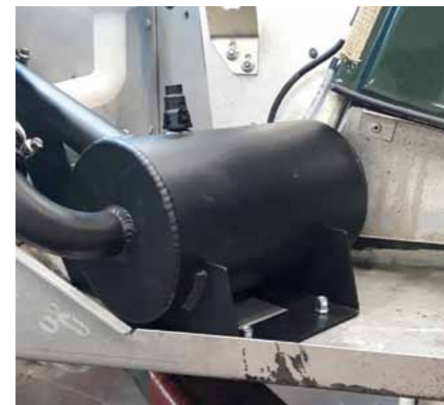
Swirl Pot, das linke Bild zeigt den Einbau unter dem Kotflügel bei einem Plus Six und das rechte Bild den Einbau vorne im Motorraum bei meinem Plus Four. Hoffentlich ist damit dann das Kühlerproblem gelöst, im Moment sieht es so aus
