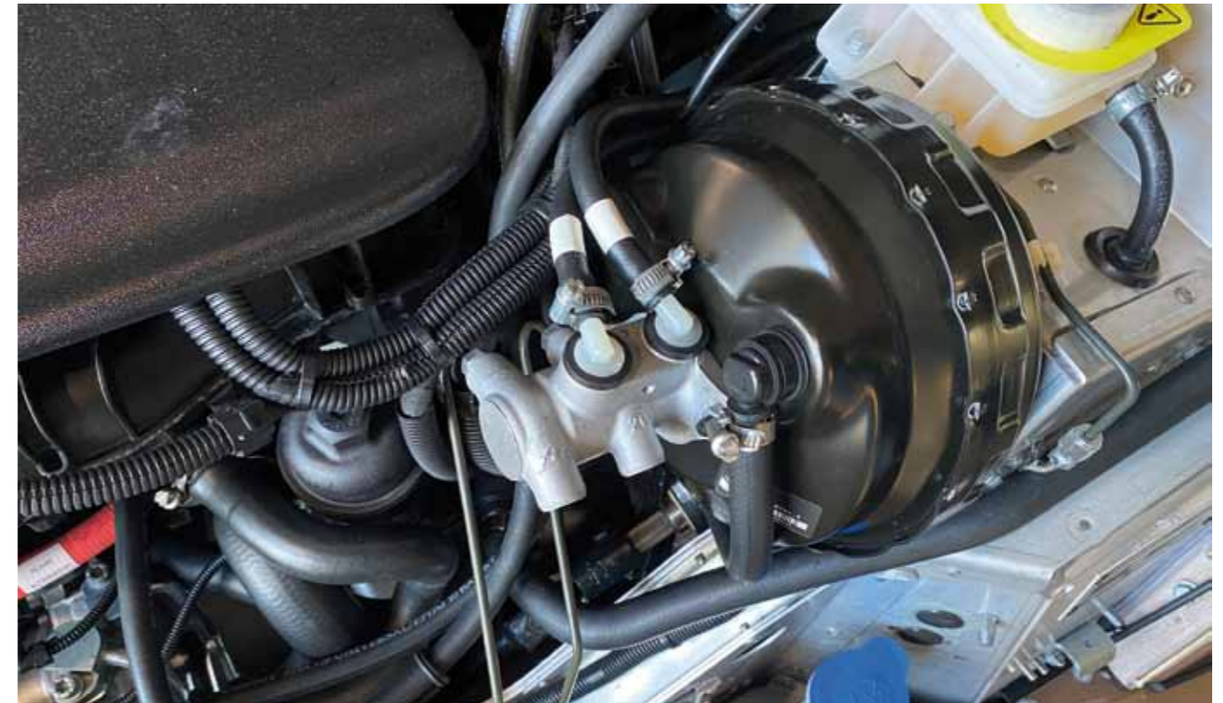
Ab dem Modelljahr 2023 wurden AP-Racing/ATE Bremsanlagen bei Morgan verbaut. Der Bremskraftverstärker ist jetzt 9 statt bisher 7 Zoll und produziert stärkeren Bremsdruck bei geringerem Kraftaufwand. Er kommt ebenso wie der Bremszylinder von der ContiTochter ATE
