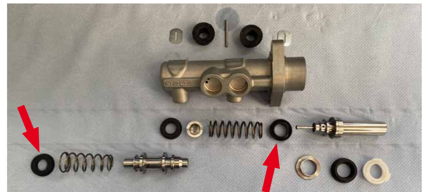
In der Flaving-Werkstatt wurde der Bremszylinder auseinandergenommen, optisch konnte man den möglichen vorzeitigen Verschleiß nicht feststellen. Um die markierten Dichtungen ging es - der 1. und 2. Bremskreislauf
