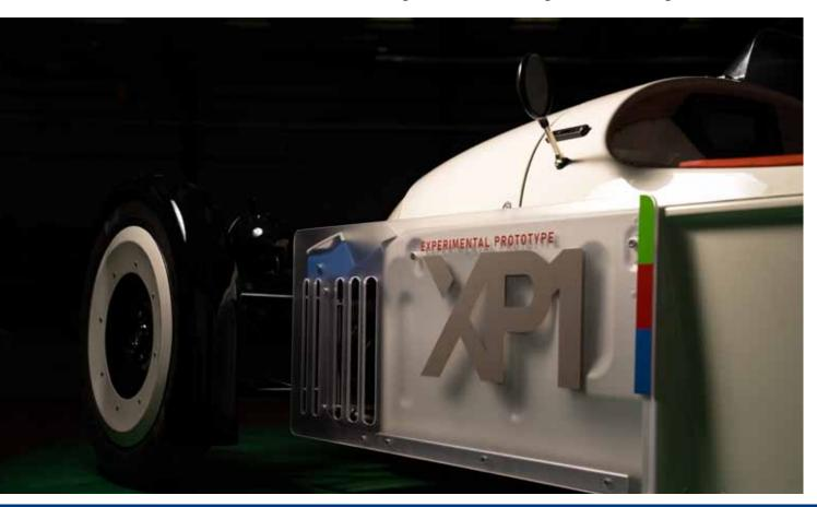
Verständnis für die umfassendere EV-Technologie und das Design, insbesondere die Aerodynamik, zu entwickeln. Der XP-1 verfügt über aerodynamische Verbesserungen an der Frontpartie für mehr Reichweite und Effizienz. Diese experimentellen Modifikationen, die für den normalen Betrachter kaum sichtbar sind, haben zu einer Reduzierung des Luftwiderstandsbeiwerts um 33 % geführt.
